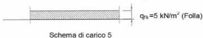
Figura 5.1.2 - Schemi di Carico 1-5 Dimensioni in [m]
