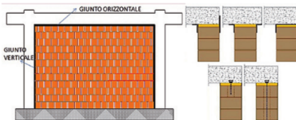
1. Soluzione svincolata con giunto e possibili dettagli costruttivi anti-ribaltamento.
