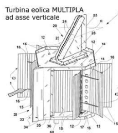
Turbina eolica ad asse verticale con elementi di presa sul vento AUTO-ORIENTABILI
