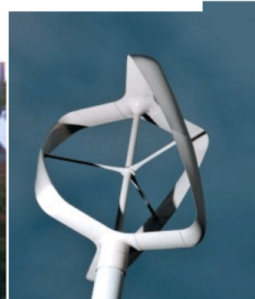
Figura 4 – architetture di turbine ad asse verticale operanti sul principio della portanza. Tipo a,b,c turbine Darrieus, tipo d, turbina Gorlov
